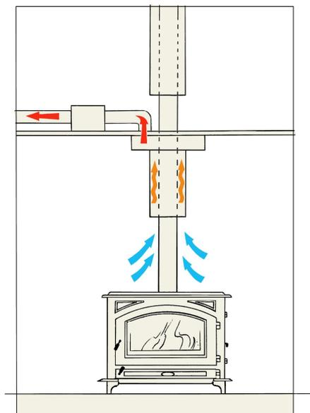
Le collecteur de calories RPB 150 s'adapte sur tous les poêles à bois\* d'une puissance minimum de 7 kW et sur un tuyau de fumée diam 150 (\*bûches exclusivement)
